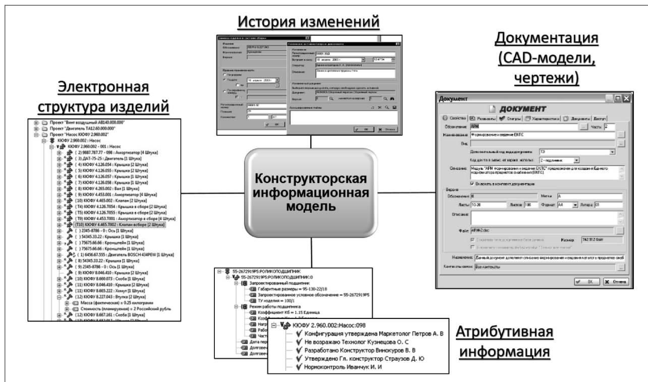
Рис. 2. Структура конструкторской информационной модели (часть цифрового прототипа изделия)
